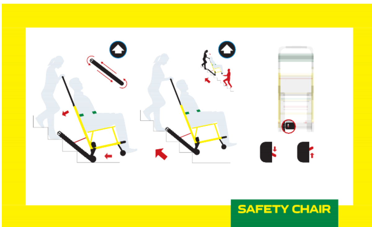
Rys. Prezentacja kolejnych etapów ruchu w górę schodów krzesła ewakuacyjnego EV-9000 przy użyciu napędu.
